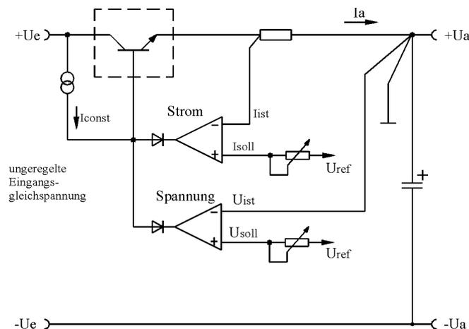
Bild 2.1: Vereinfachtes Spannungsreglerschema
