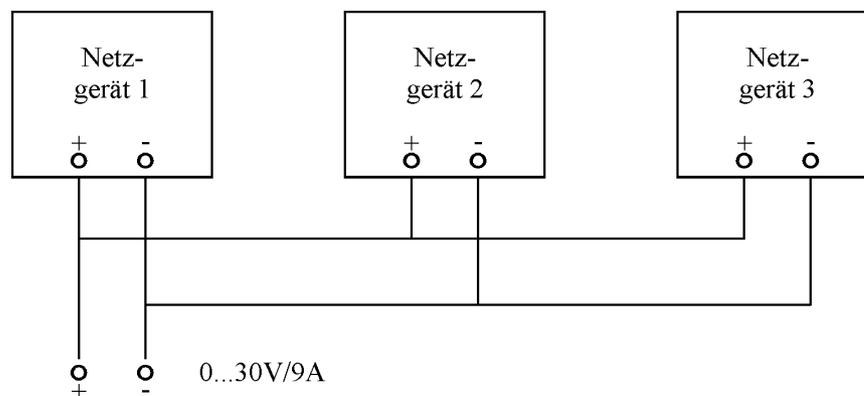
Bild 5.2: Parallelschaltung
