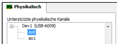
Abbildung 9 DAQ-Assistent: Kanalauswahl „Analog Out 0“
