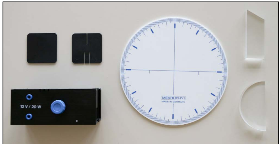
Abbildung 1 Komponenten für den Versuch (v.l.n.r.): Experimentierleuchte mit Voll- und Schlitzblende, Winkelscheibe, Prisma/Platte und Halbzylinder
