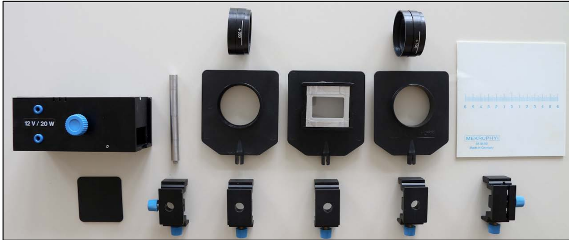
Abbildung 1 Komponenten für den Versuch (v.l.n.r.): Experimentierleuchte mit Vollblende, Stativstange und Reiter mit Schraube, Linse f' = 300 mm mit Linsenhalter und Reiter, Transmissionsgitter in Diahalter mit Reiter, Linse f' = 100 mm mit Linsenhalter und Reiter, Schirm mit mm-Skala und Reiter mit Schlitz
