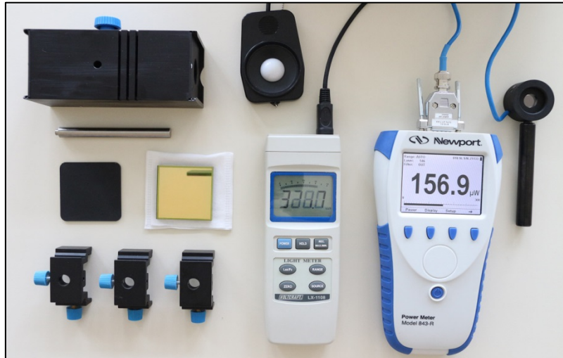
Abbildung 1 Komponenten für den Versuch: Experimentierleuchte mit Verschlusscheibe, Stativstange und Halter, Grünfilter, Luxmeter, Leistungsmessgerät mit Si-Detektor
